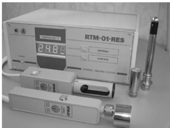
Диагностический микроволновый радиотермометр РТМ-01-РЭС
