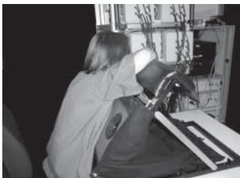
Рис. 7. Кольцевые держатели оптоволоконных датчиков и поддерживающая рамка, подключенные к сканирующей системе MONSTIR при проведении томографического исследования МЖ
