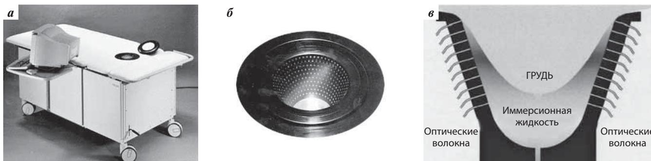
Рис. 1. Оптический томограф OMPS: а, б – внешний вид; в – схематическое изображение сканирующей системы в разрезе
